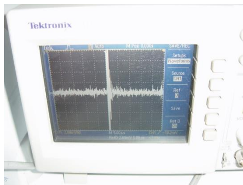
شکل ۵: ولتاژ طبقه‌ی خروجی به وسیله‌ی اسیلوسکوپ دیجیتال
