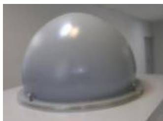
شکل ۴: گنبدی ساخته شده برای پمپ ۶۰ متر مکعب بر ثانیه‌ای
