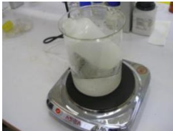
شکل ۶: استفاده از روش حمام آب گرم برای خشک کردن مخلوط رادیواکتیو
