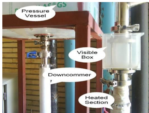
شکل شماره (۲) قسمت قابل رؤیت در تست لوپ ترموهیدرولیکی SHUNCL
