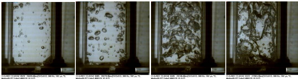
شکل شماره (۳) نمونه تصاویر رژیم های مختلف جریان در تست لوپ SHUNCL
