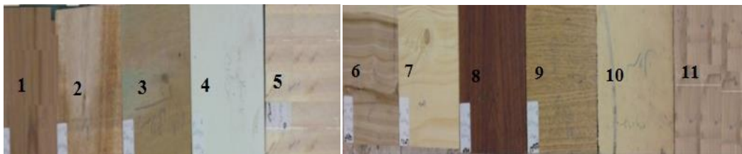
شکل ۱: چوب‌های استفاده شده در آزمایش: ۱. راش، ۲. افرا، ۳. ملج، ۴. نتوپان، ۵. صنوبر، ۶. تبریزی (سپیدار)، ۷. روسی، ۸. ام دی اف، ۹. لترون، ۱۰. سه لایی، ۱۱. بلوط
