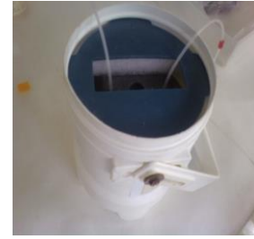
شکل ۴: ژنراتور با ستون ۵ سانتی متری با قابلیت حمل ۵۰۰ میلی کوری اکتیویته
