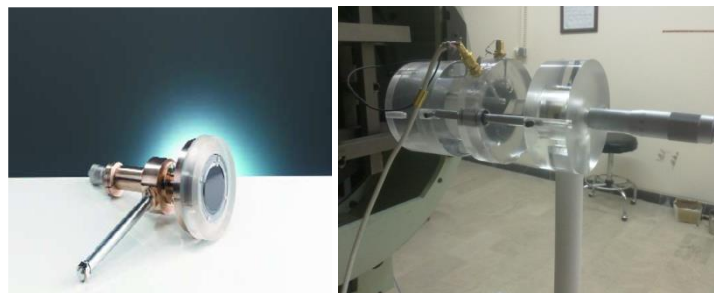
الف) نمایی از اتاقک یونش ساخته شده با حجم متغیر ب) نمایی از اتاقک یونش با حجم متغیر ساخت PTW
