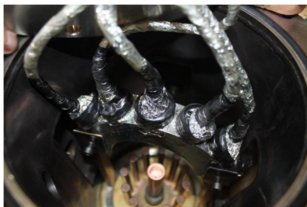
شکل شماره (۲). آرایه فنجان فارادی در محفظه اصلی دستگاه پلاسمای کانونی
