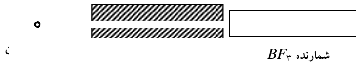
شکل ۲ تهیه باریکه نوترونی از یک چشمه نقطه‌ای برای شمارنده BF_3
