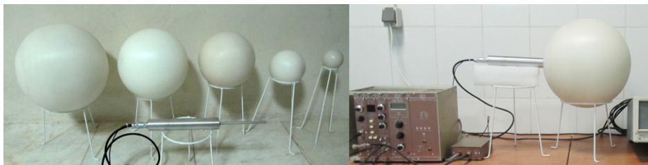
شکل ۱: مجموعه‌ی کره‌های ساخته شده در این پروژه، به عنوان کند کننده‌های سیستم اسپکترومتری نوترون به همراه دتکتور Li-Glass
