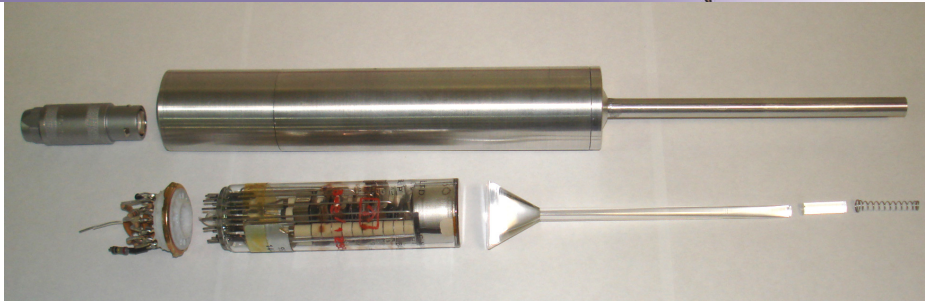
شکل ۲: تصویر قطعات دتکتور ساخته شده در این پروژه، برای آشکارسازی نوترونهای حرارتی
