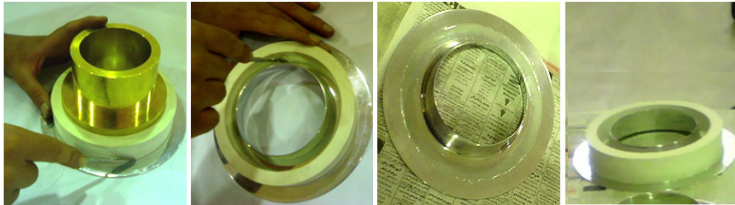
شکل ۴: مراحل اتصال و چسبکاری الکترو و سرامیک
