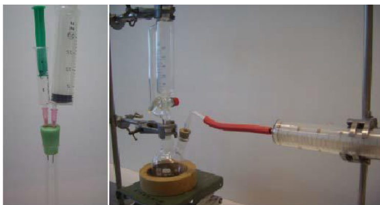
شکل ۴: مقایسه دستگاه تولید گاز ارزان با تجهیزات آزمایشگاهی مرسوم
