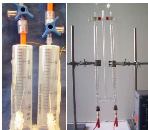
شکل ۳: مقایسه ولتامتر هافمن ساخته شده از وسایل پزشکی و نوع شیشه ای آن
