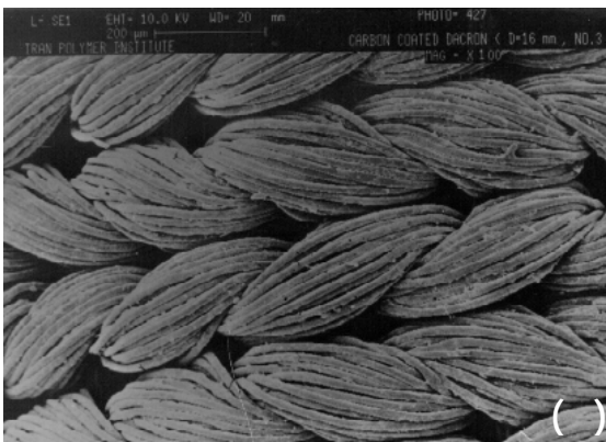
شکل ۲- تصاویر میکروسکوپی از سطح پروتزهای عروقی (الف) پروتز با پوشش گرافیت (ب) پروتز بدون پوشش
