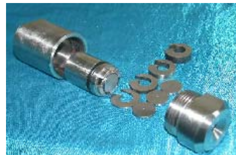
شکل ۱ - قطعات نازل ساخته شده به ترتیب از راست به چپ، Screw Orifice Head، Adapter Spacer End Plate
