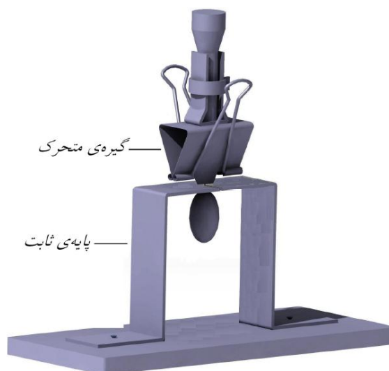
شکل 5- یک نمونه از آزمون جدایی دم از حبه را با استفاده از ابزار ساخته شده
