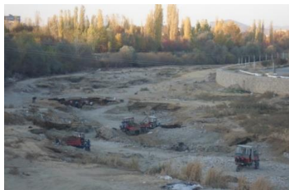
شکل 3. تخریب رودخانه برای برآشت شن و ماسه
