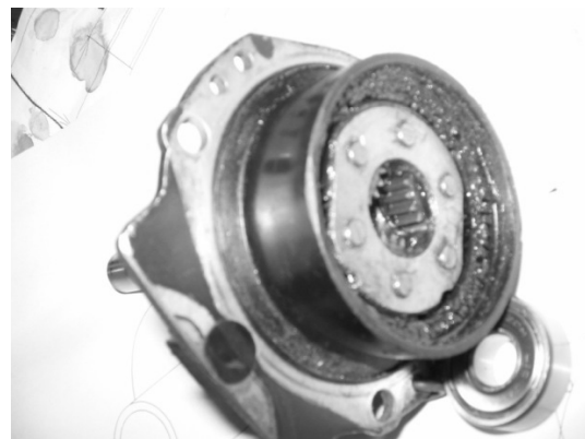
شکل ۲. جعبه‌دنده دنده‌سیاره‌ای انتخاب‌شده
