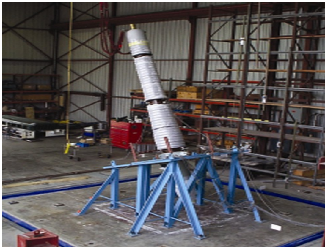
بوشینگ 550KV قبل از تست زلزله در دانشگاه برکلی
