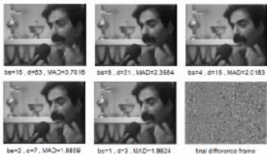
شکل ۱۰: جبران‌سازی حرکت بر طبق روال استفاده شده در شکل ۸ و با اعمال جبران‌سازی شدت روشنایی
