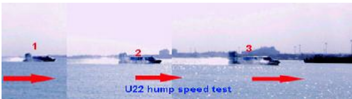
شکل ۴) تست هاورکرافت یونس ۲۲ در زمان عبور از HUMP
