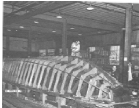
شکل ۱۵ - روش ساخت معکوس در ساخت یک شناور چوبی.
