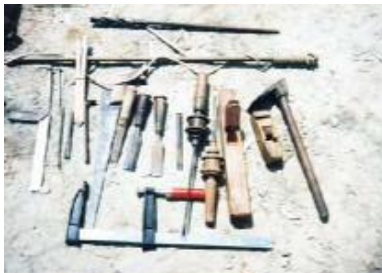
شکل ۹ - ابزارهای ابتدائی در ساخت لنج.
