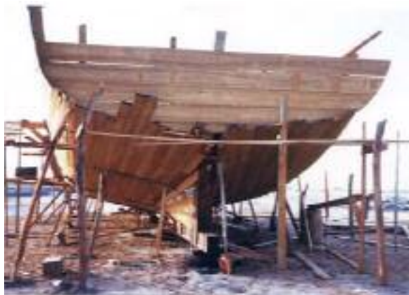
شکل ۸ - چیدمان الوارها در دیواره های عرضی لنج.
