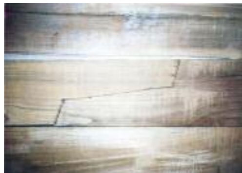
شکل ۶ - اتصال در بین قطعات الوار در الوارگذاری پوسته خارجی لنج.
