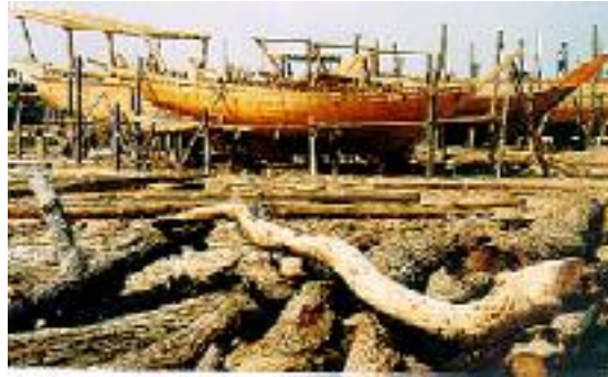
شکل ۴- ساخت لنج از چوب درختان.
