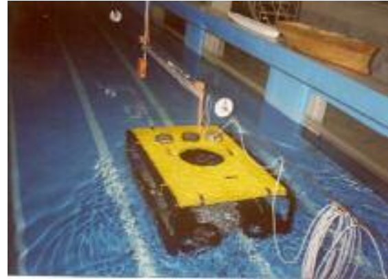
شکل ۶- نمایی از SUTRO-1 در تانک کشش برای شناسایی پارامترهای هیدرودینامیکی
