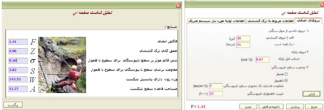
شکل ۳- نیروهای اضافی جهت تحلیل شکست صفحه ای. شکل ۴- خروجی های تحلیل شکست صفحه ای
