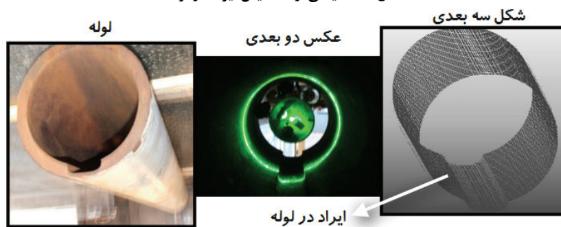
شکل 2- نمایشی از تشخیص ایراد در لوله
