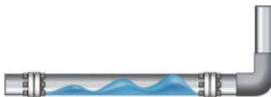
شکل 2- نمونه ای از موج کاندنس ایجاد شده در یک سیستم برگشت کاندنس
