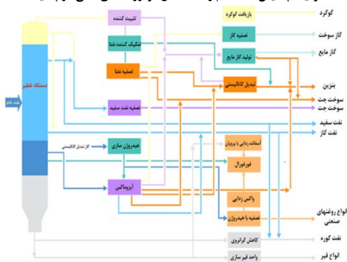
شکل 1 - فرآیند پالایش نفت خام و استحصال فرآورده های نفتی در پالایشگاه اصفهان
