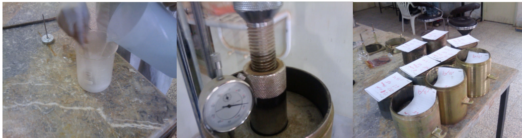
شکل 4- قالبهای آماده آزمایش CBR شکل 5- قالبها در زیر دستگاه CBR شکل 6- حل کردن رزین در آب
