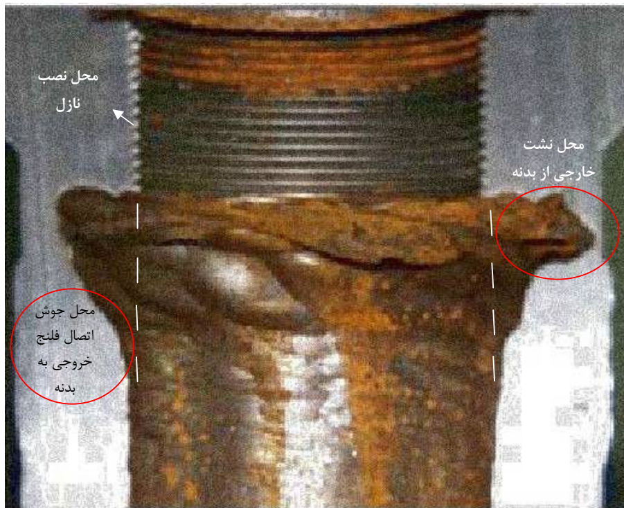
شکل 5- برش عرضی از کاهنده، کاهش ضخامت شدید در خروجی کاهنده در نزدیکی محل قرار گیری نازل
