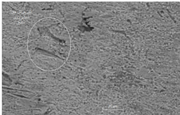
شکل 7- تصویر SEM از سطح فلز در میانه خروجی کاهنده
