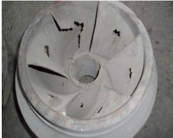
شکل 3- تخریب های رخ داده روی سطح پره های یک پمپ ناشی از پدیده کاویتاسیون
